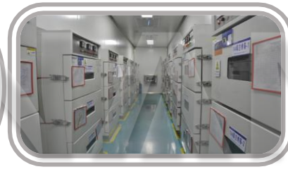
露点 <-60^{\circ}\text{C} 环境下 烘烤
